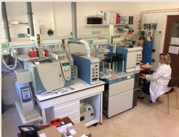
Spectromètre de masse à flux continu (CF-IRMS) ayant servi à l'analyse des rapports isotopiques du soufre et de l'oxygène de l'albâtre du gisant (Direction des laboratoires du BRGM).
