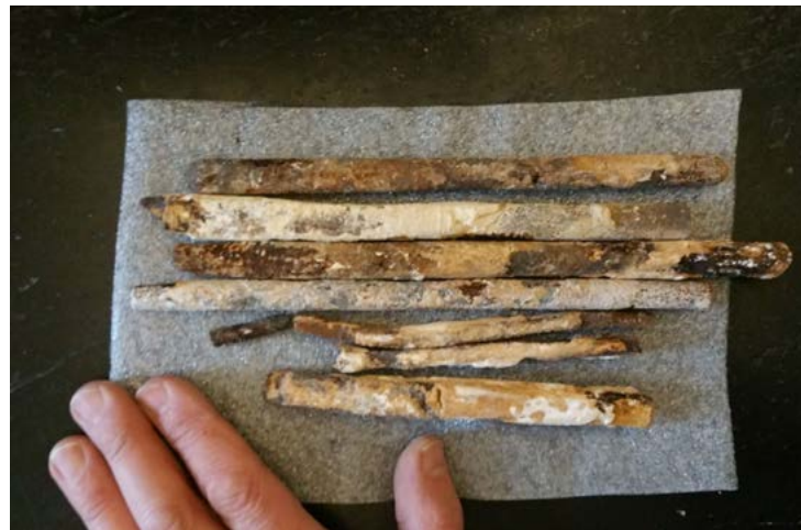
Id. Goujons en fer extraits de la semelle de calcaire et du gisant.
