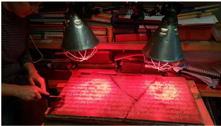
Restauration de 2015-2016. Plaque gravée en marbre noir imprégnée de cire à chaud sous deux spots infrarouges.
