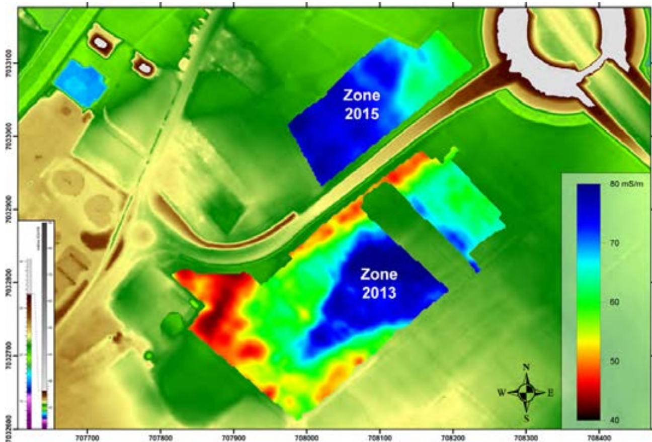
Carte de conductivité électrique du sol par EM31 de la zone prospectée en 2015 au nord de la route menant à la rocade de Douai et au sud, zone prospectée en 2013, sur fond de MNT.
