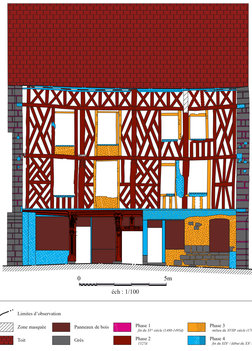
Fig. 1 : Épernon (Eure-et-Loir) 5-7 place du Change : relevé phasé de la façade sur rue. (T. Lacroix, Direction de l'archéologie de Chartres métropole)
