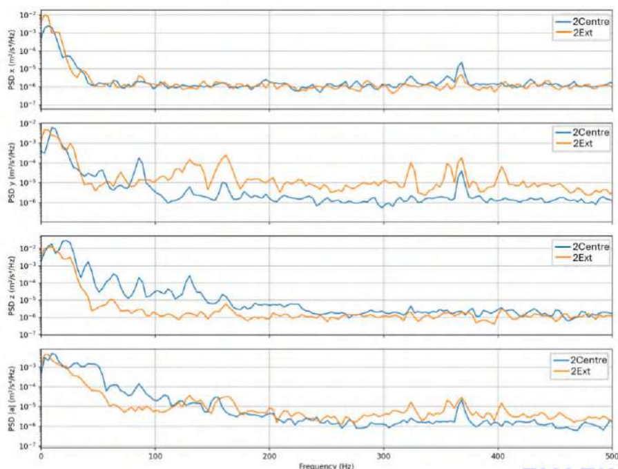
Figure 94 : Valeurs d'accélération au cours du temps sur 30 minutes sur une [redacted] (retour, février 2026). Les valeurs du capteur 2Ext (caisse interne) sont tracées en orange, celles du capteur 2Centre (panneau 2) en bleu.
