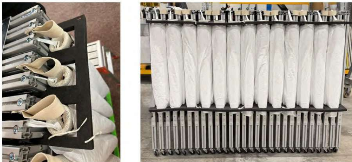
Figure 116 : Modules en plastazote, permettant de sécuriser les tubes externes. ©Th. BOUZID
