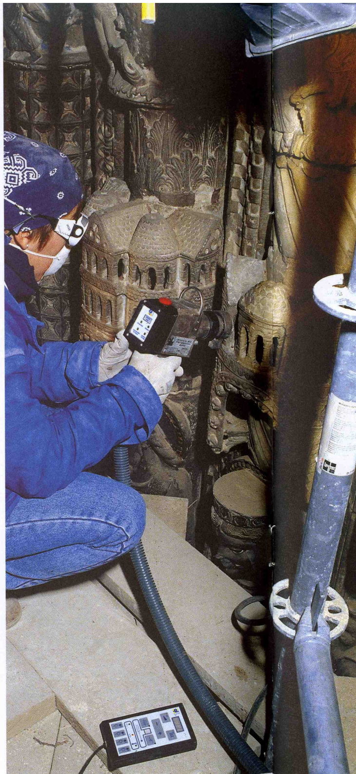
Pour identifier les différentes couches stratigraphiques présentes sur le tuffeau de l'escalier François Ier du château de Blois (liants, fixatifs et produits de restauration), le Laboratoire de recherche des monuments historiques a procédé à une chromatographie en phase gazeuse couplée à la spectrométrie de masse
