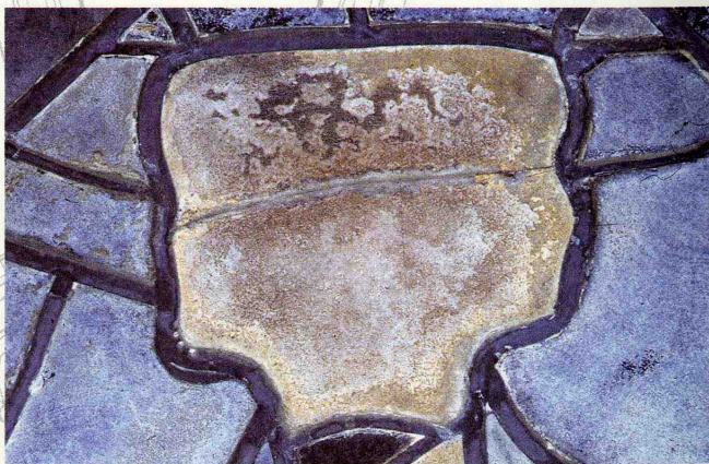
Face externe d'un panneau (détail) : micro-crâtes et plombs de casse perturbent la lecture.
