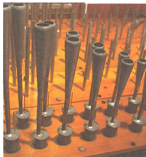
Corps du Bassoon 16 avec les bagues de réglage.
