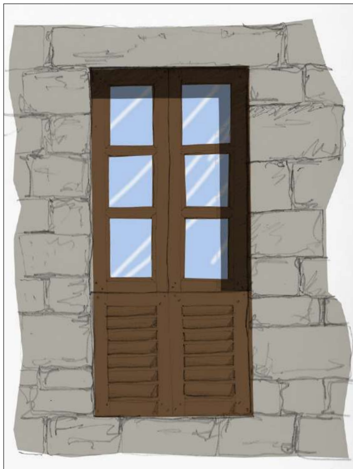
Aux étages, les allèges des baies peuvent être déposées en vue d'y aménager le moteur de climatisation. La menuiserie fermant l'alcôve devra alors reprendre le vocabulaire des menuiseries : ici des volets à persienne ont été installés.
