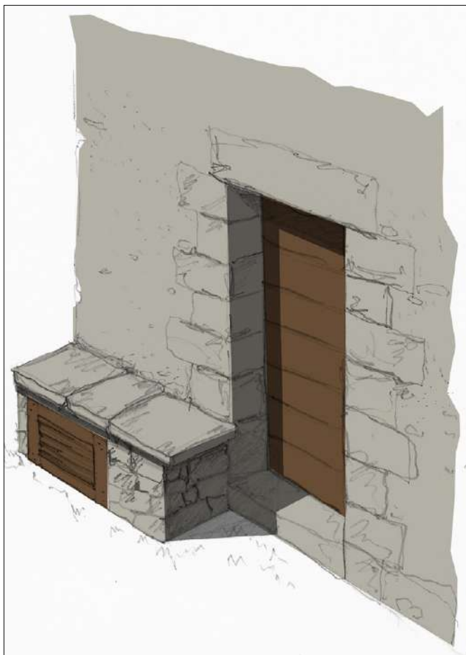
Les moteurs de pompe à chaleur peuvent être intégrés à des éléments architecturaux commun dans le langage villageois de Bastelica : ici un banc de convivialité habille la niche aménagée pour l'équipement. L'ouverture est fermée d'un volet en bois.
