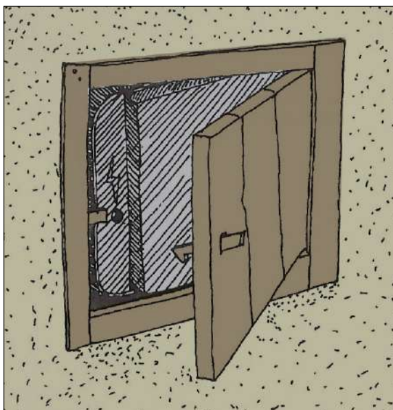
Le compteur peut être occulté par l'installation d'un volet en bois plein dans la façade de la construction (ou de la clôture maçonnée).
