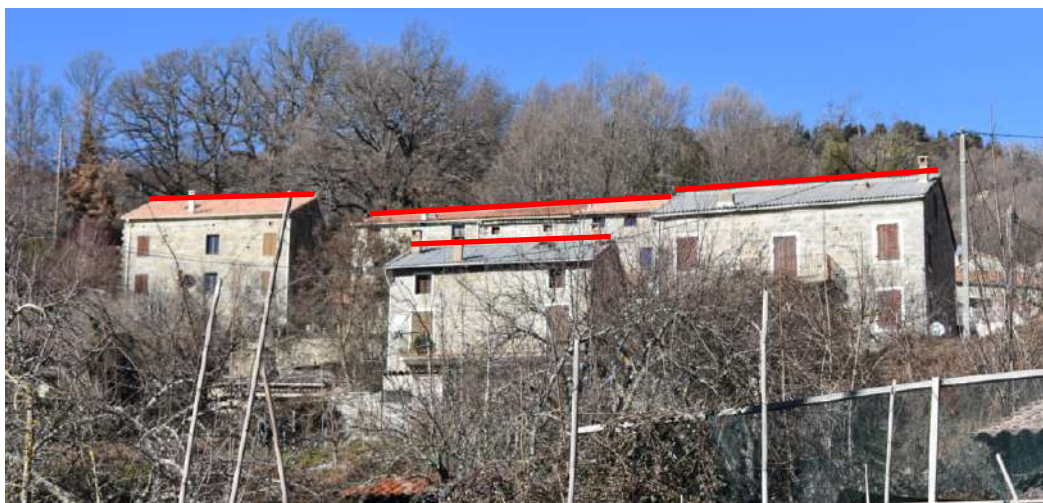
Quartier de Costa : les faitages des constructions s'orientent parallèlement aux courbes de niveau, les volumes bâtis s'étagent selon la topographie, dégagant des vues pour les constructions en amont.
