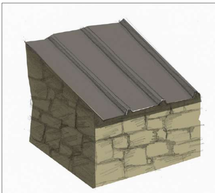
Bac acier s'apparentant à un zinc joint debout (type batichip ou équivalent)
