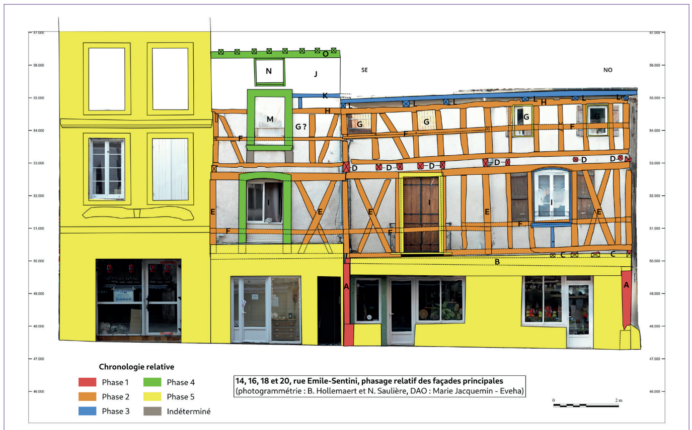
AGEN, Les dynamiques de l'habitat à Agen, fig. 1. : Agen, rue Émile-Sentini, n° 14, 16, 18 et 20. Phasage relatif des façades principales en pan de bois de trois modules contemporains d'un lotissement. Le quatrième a subi une pétrification. (photogrammétrie: B. Hollemaert et N. Saulière ; DAO : M. Jacquemin – Eveha).
