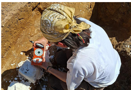
Prélèvement de la paroi d'un bas-fourneau pour datation archéomagnétique, 2025. © Cristina Gandini.
