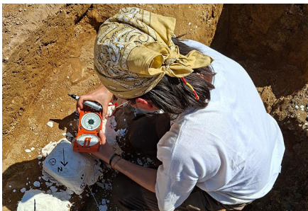
Prélèvement de la paroi d'un bas-fourneau pour datation archéomagnétique, 2025. © Cristina Gandini.
