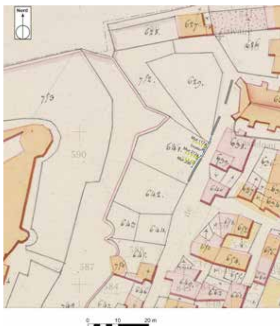
Fig 6 : recalage des maçonneries découvertes dans le sondage, sur le plan cadastral de 1818, avec correction géométrique basée sur le levé cadastral actuel (plan-masse en jaune en transparence) (DAO : Fr. Chaléat).
