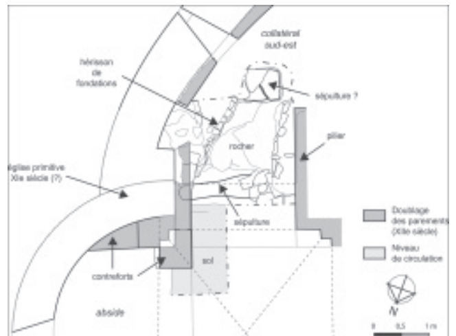
Ci-dessus : Plan de la fouille et du sondage dans le parement sud-est de la crypte (reprise d'une fouille clandestine de 1968) : les parements de l'église primitive, construite sur des sépultures rupestres, ont entièrement été chemisés au XII e siècle (dessin : M. Chaillon, Hadès).
