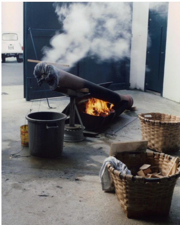
Photographie 10: Tube rempli d'eau au sein duquel les membrures sont étuvées avant d'être ployées (Photographie de la famille Marin, prise lors de la construction du batteliku Kuxto en 1993)
