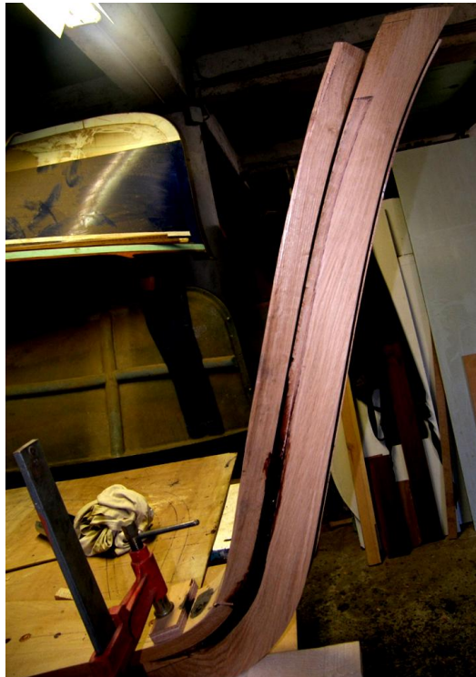
Photographie 6: sur cette photographie prise au chantier Marin en 2010, nous voyons à quel point les fibres de chêne correspondent avec les courbes de l'étrave qui en est issue.
