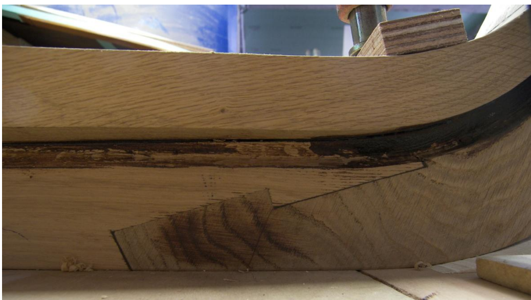
Photographie 7: exemple d'assemblage entre la quille et la pièce d'étrave (chantier Main 2010)
