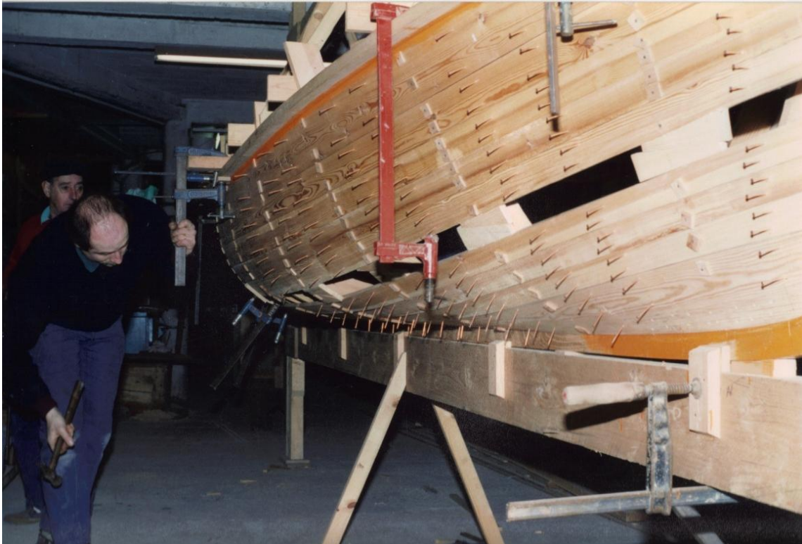
Photographie 9: Luisito Marin positionnant les rivets en cuivre le long de Kuxto avant la mise en place des membrures, nous apercevons ici l'espace libre entre les bordés ou sera positionné la clé ou le dernier bordé. (Photographie de la famille Marin, prise lors de la construction du batteliku Kuxto en 1993)
