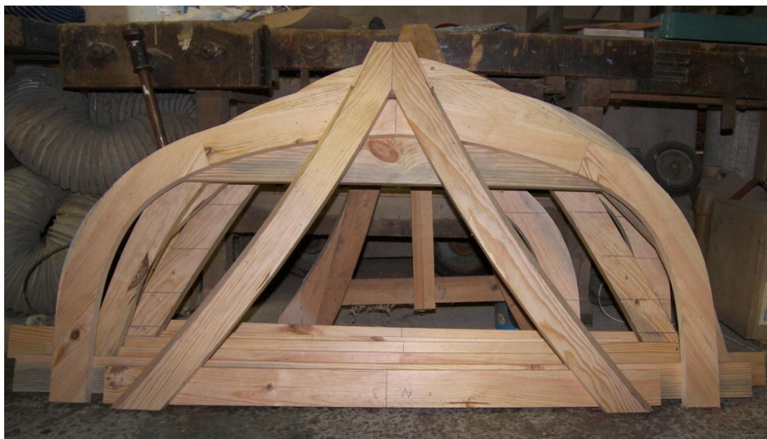
Photographie 5: gabarits construits en 2010 au chantier Marin lors de la construction d'un canot à tableau
