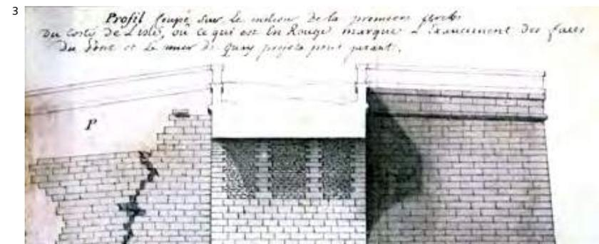
3. Détail montrant la culée du pont implantée sur la rive gauche et le mauvais état du mur de quai dans lequel une importante lézarde est visible. AN F14 10202/3/3. A. Dumont
