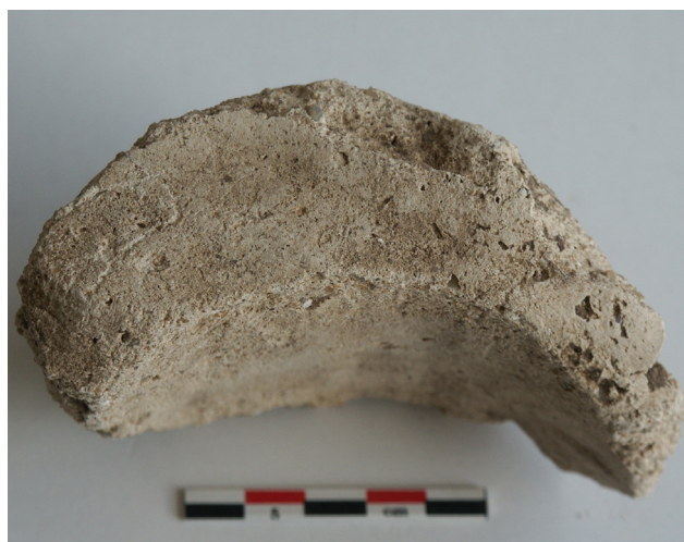
III. 4 : Vieil-Évreux (Eure), thermes. Joints de tuile en mortier de chaux et sable siliceux entre deux imbrices, 2003. Cliché A. Coutelas.
