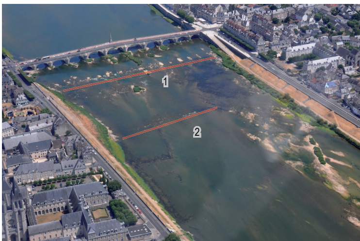
5 /// La Loire vue vers l'est. Au-devant des vestiges du pont médiéval (1), une large bande plus sombre correspond au bombement (2).
