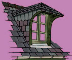
Réalisée entièrement en charpente, couverte et bardée d'ardoises, la lucarne "capucine" est assez étroite, avec une fenêtre de 100 x 60 cm environ et des montants de 10cm.
