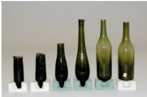
Étapes de fabrication d'une bouteille à champagne , vers 1854.
