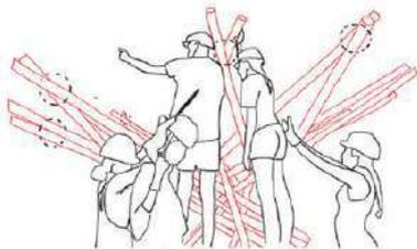
On élève encore la structure pour lier les bambous par un point central. Au total, chaque bambou est relié en trois points à trois autres bambous, créant des efforts réciproques. Afin de garder la forme générale stable, on vient ancrer la structure sur un socle.
