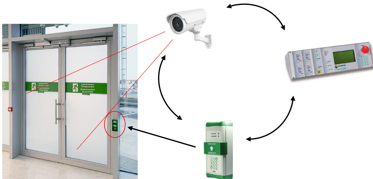
Unité de gestion centralisée des issues de secours
