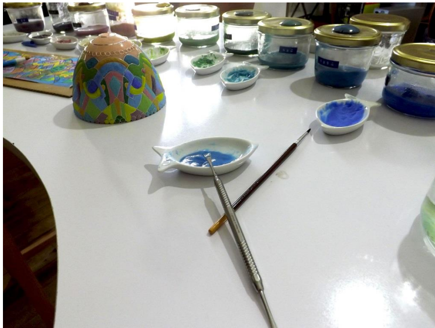
III. 8. La poudre est mélangée à l'eau avant d'être posée à l'aide d'une spatule. © Les Émaux arédiens.
