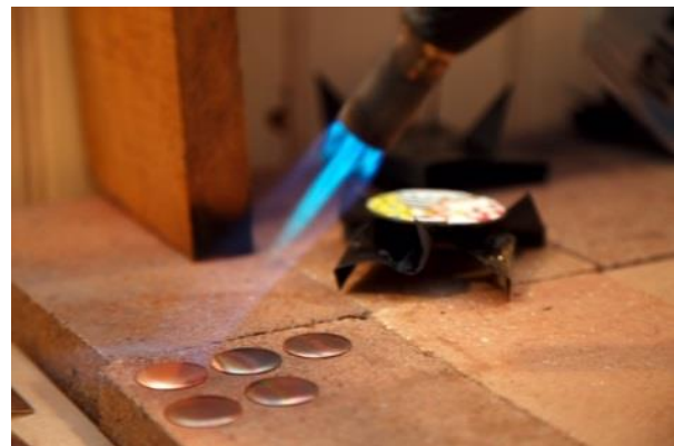
III. 6. Chauffe de la plaque de cuivre au chalumeau. © Guillaume Villégier
