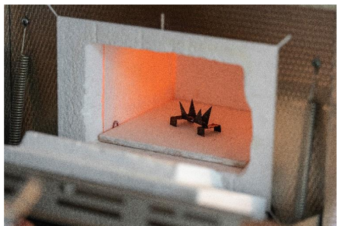
Ill. 11. La pièce est enfournée sur un support. © Inas Hamaguchi.
