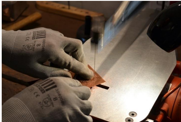
III. 4. Découpe du cuivre à la scie à chantourné. © Hélène Chaudet.
