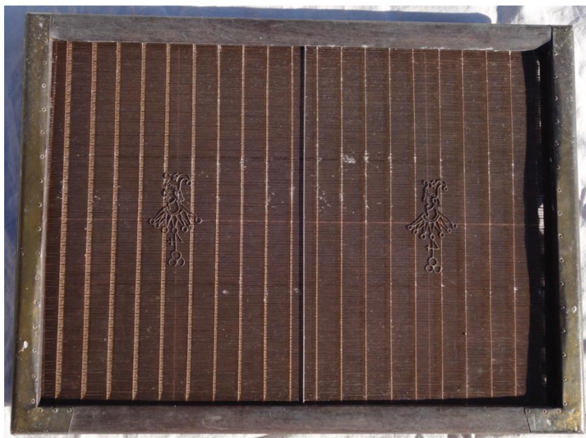
Forme vergée vue de dessus avec filigrane © Moulin du Verger
