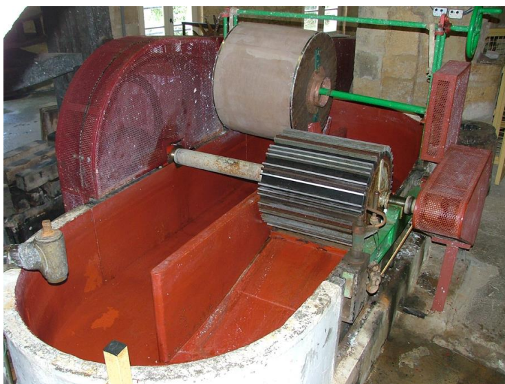
Un cylindre hollandais © Moulin du Rouzique
