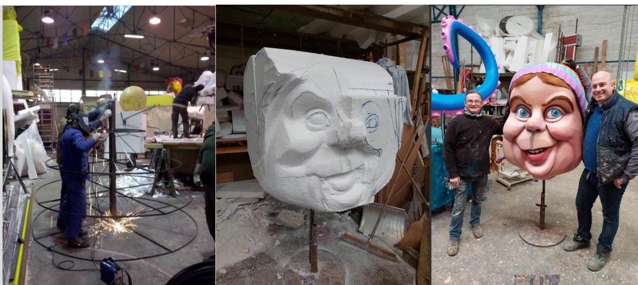
À gauche, soudure d'une armature avant pose du polystyrène, blocs de polystyrène numérotés pour la découpe et recouvrement d'une armature par les éléments d'un chien en polystyrène, © Facebook "les Zamuz Rue", 2017. Au centre, confection d'une tête pour un char : le début du façonnage du polystyrène, à droite : Gérard Dupond et Cyrille Duret montrent la tête après peinture, © Cyrille Duret
