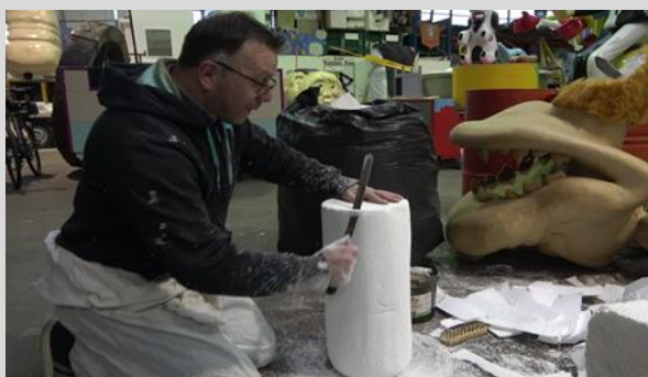
Capture d'écran extraite d'une séquence vidéo sur la fabrication des chars où Christophe Chalon est en train de façonner plus finement le morceau de polystyrène à l'aide d'un couteau à grosses dents, avant de le poncer à la brosse, Source Vidéo : ©Marjorie Ruggieri, 2021, N.E.M.O. : 2_PROJCARN_REP_10_0047
