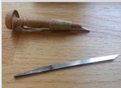
*Lame non montée et non façonnée en bas, burin composé d'une lame façonnée en haut, atelier de Sarah Lazarevic*
