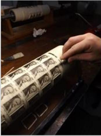
*Découpe des rouleaux toucheurs-encreurs par un imprimeur taille-doucier, imprimerie de Philaposte à Boulazac*
