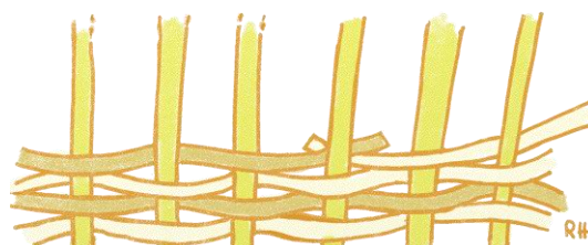
Fig. 6 – Schéma du tressage des flancs : 1 brin, derrière 1 devant 1
