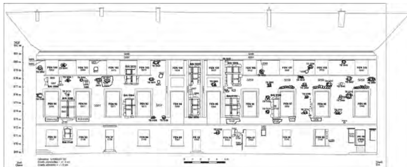
Fig. 29 – EMBRUN, Ancien archevêché, aile sud. Mur M25, relevé des structures découvertes, 1/125 e (DAO N. Nicolas-Girardot).
