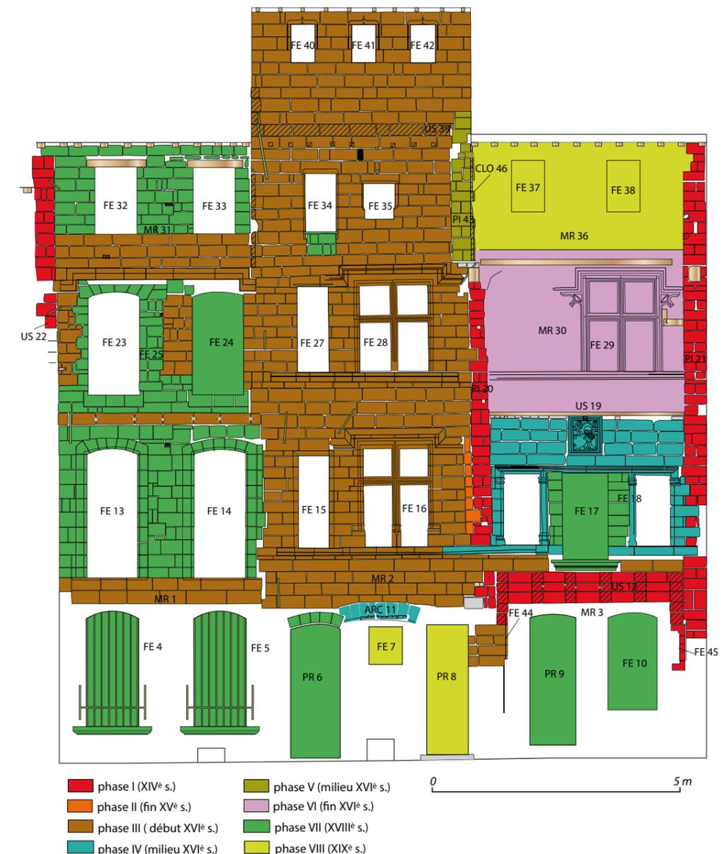
Fig. 152 – AVIGNON, 4, rue Armand de Pontmartin. Relevé pierre à pierre de la façade et phasage des élévations (DAO : G. Baro/SACDV).
