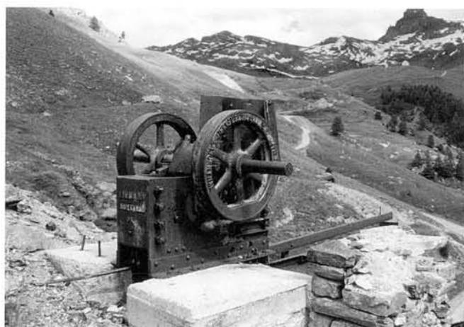
Fig. 25 — SAINT-VÉRAN, Mine de cuivre des Clausis. Broyeur à mâchoires laissé *in situ* (Actilia Multimedia).
