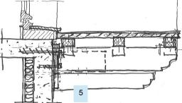
Balcon tout bois avec renfort de console par platine métallique scellée et boulonnée dans maçonnerie neuve
