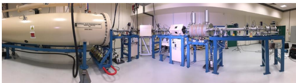
Spectrométrie de masse par accélérateur du LMC14 utilisé pour dater les cosmétiques (c) CEA/L. Godart
