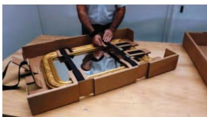
Mise en place du produit (Miroir) sous les pattes de maintien renforcées
