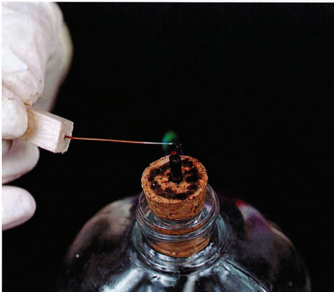
Pour éviter de se brûler les doigts, le fil de cuivre est planté dans un tasseau de bois mou, du balsa. Le fil est chauffé blanc avant d'être mis en contact avec le matériau à analyser. Il est immédiatement ramené la flamme qui tourne alors au vert si l'échantillon contient l'ion chlore.
