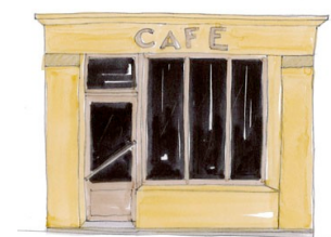
Devanture en maçonnerie enduite. Lettrage en enduit ou directement peint sur la façade.
