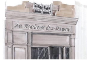
Enseigne bandeau lettres découpées fixée dans le cadre du bandeau de l'applique
