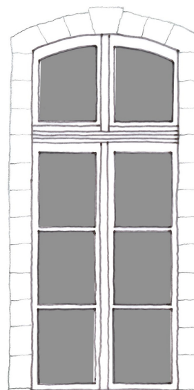
Baie du XVIII e siècle avec une menuiserie modifiée au XIX e siècle : la traverse et l'imposte ont été conservées, un petit bois sur deux a été supprimé pour mettre en place des grands verres. © Atelier G. André
