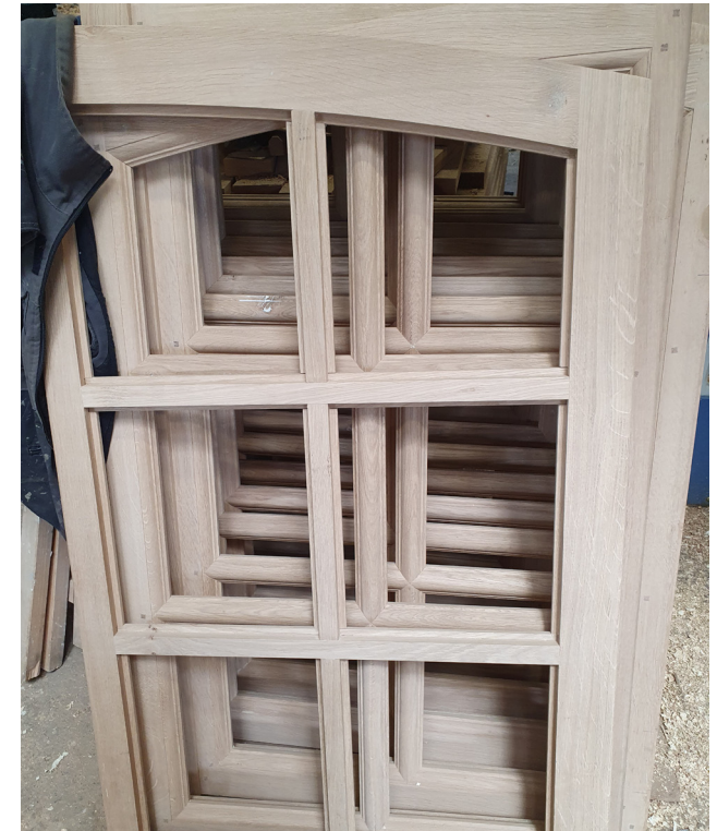
Menuiseries neuves à petits bois pour recevoir un double vitrage, 10 mm , remplissage gaz krypton © Atelier G. André
