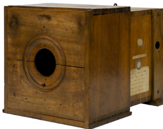
Chambre de la découverte, premier appareil photographique au monde utilisé par Nicéphore Niépce, années 1820, © musée Nicéphore Niépce, ville de Chalon-sur-Saône
