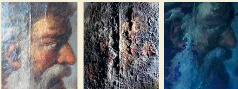
Fig. 3 - Visage d'Ananie en lumière naturelle frontale, lumière rasante (mettant en évidence les soulèvements) et lumière ultra-violette (identification des repeints en noir) (Malbrel Conservation, 2024).
