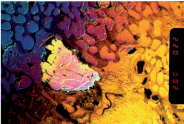
Micrographie d'un échantillon de culot de forge, laboratoire Métallurgie et Cultures, UMR 5060 du CNRS, Institut Polytechnique de Sevenans. Photo. Ph. Fluzin.
