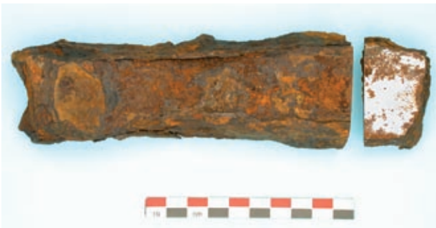
Demi produit de fer coupé pour analyse métallographique au laboratoire Métallurgie et Cultures, UMR 5060 du CNRS, Institut Polytechnique de Sevenans. Photo. M. Berranger.
