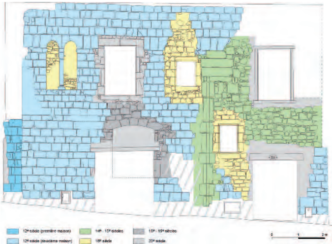
Figure 2 : Poitiers, relevé de la façade sur la rue avant restauration (relevé : L. Prysmicki)
