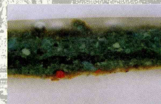
Fragments de polychromie vus au microscope électronique à balayage
