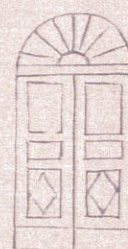
Principe de division des panneaux bois
