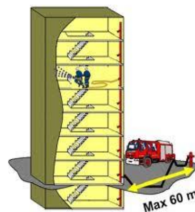
Principe de fonctionnement d'une colonne sèche
