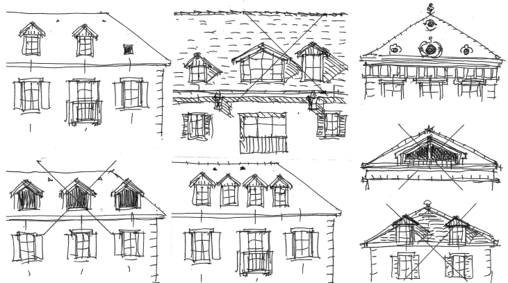
Série d'interventions en toiture dont certaines inadaptées (dimension, position, etc)
