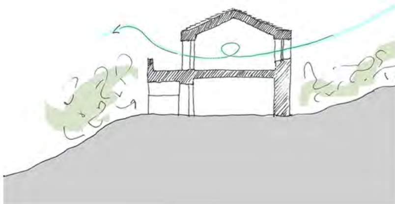
L'été, le soleil est plus haut dans le ciel que l'hiver. Le choix de l'orientation de la maison est important pour le confort thermique. Les rayons du soleil ne parviennent pas à entrer à l'intérieur de la maison l'été car le soleil est dans une position très verticale; l'hiver il entre dans la profondeur de la maison pour la chauffer.
