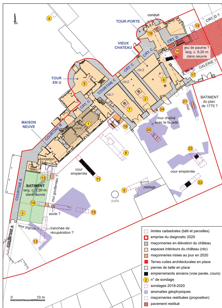
Le Neubourg, Vieux Château : plan général des maçonneries et empierrements anciens mis au jour en 2020, des anomalies géophysiques, et propositions de restitutions de certaines constructions disparues (murs, pavement, charpente, bâtiments) (plan bâti : Cabinet Caldea ; topo : M. Osmond ; DAO : G. Deshayes).
