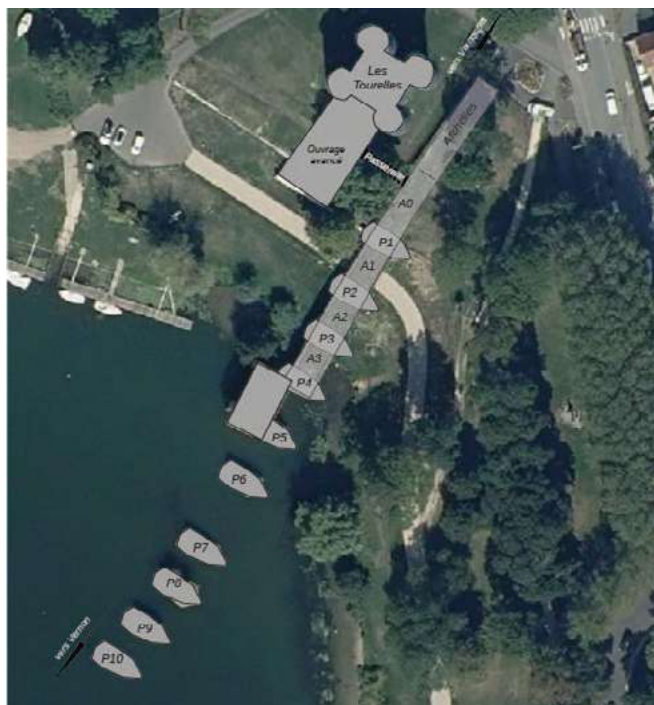
Vernon, Vieux Pont : état des vestiges conservés (DAO : P. Fajon).
