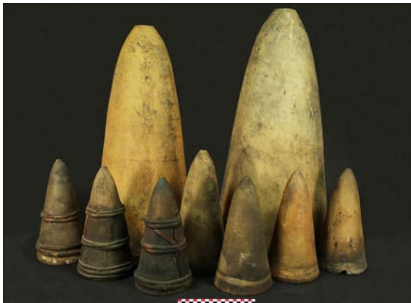
Céramiques de raffinage : formes à sucre provenant de la raffinerie rouennaise du 85 rue des Carmes, conservées au musée des Antiquités de Rouen. Les équipements et traces de réparations sont visibles sur ces exemplaires (S. Le Maho).
