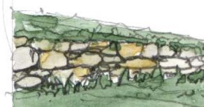
Mur de soutènement
