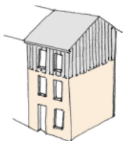
Surélévation simple en zinc.
