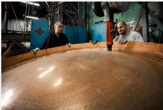
Fig. 15. Le martelage du fond de la chaudière nécessite l'intervention concomitante de deux chaudronniers, Jarnac-Champagne, 11 décembre 2019. © J. Mazenq / M. Ramos, 2019.
