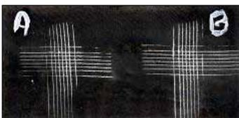
Exemple d'éprouvette après essai de quadrillage, in : *Cahier des charges pour la qualification de produits de marquage d'identification applicables aux œuvres d'art*, p. 19
